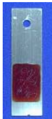
Abb.: 1 (Prüfkörper mit standardisierter Testanschmutzung)
